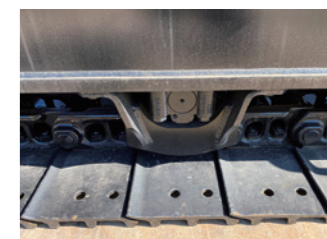
強化型トラックローラ トラックセンターガード 強化型スイングフレーム(315)
