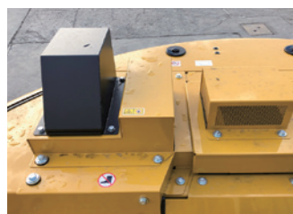
マフラーパイプガード 木屑付着による発火を防止
