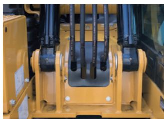
ブームフートカバー フート部への木屑堆積を防止(315-07のみ)
