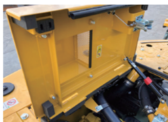
エンジン・ポンプ室隙間埋め 内部への木屑侵入を防止
