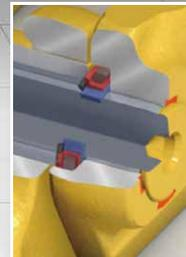
ピン・ブッシュ間にオイルを封入し、内部摩擦と外部からの異物混入を大幅に低減する高耐久性の長寿命トラックです
