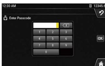
モニタ画面にパスコードを入力しエンジン始動を行う仕組みです
