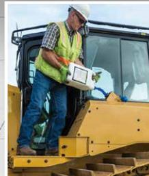
尿素水の補給口はキャブ左側ドアのすぐそばに位置しており、無理のない体制で補給することができます
