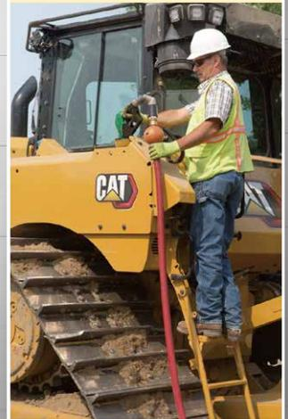
燃料補給やリアカメラの清掃、その他車両後方のサービスポイントへ安全かつ容易にアクセスが可能
