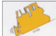
前進2.5速 後進1.5速モード 下り勾配での作業など、後進時にパワーが必要な場合に有効
