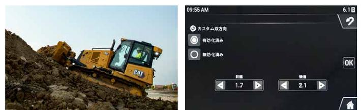
前進と後進の速度段をあらかじめ設定しておくことで前進時、後進時に自動で設定しておいた速度段が適用されます
