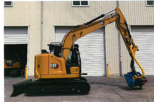
●集積用グラブを装着して集積/はく積作業に使用する場合は「伐木等機械の運転業務に係る特別教育」 掘削用バケット等を装着して掘削作業に使用する場合は「車両建設機械運転技能習得証」の取得が必要で
