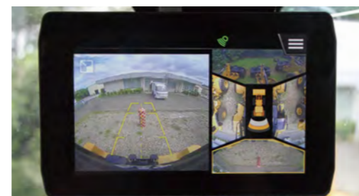
マルチビュー(前・後・左・右)からの選択映像*(左) マルチビュー(360°)カメラの映像(右)
