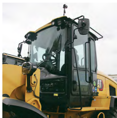
ROPS(Roll-Over Protective Structures): 転倒時運転者保護構造 FOPS(Falling-Object Protective Structures): 落下物運転者保護構造
