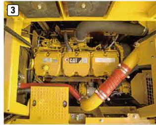
3 定格出力(ネット)361kWと高出力 Cat® C15ディーゼルエンジン
