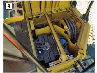
4 目立つ青色キャップで、燃料の入れ間違いを防ぐ尿素水タンク
