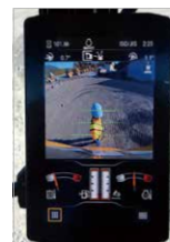
ウエイト直下まで映し出すリアビューカメラ&右側カメラ
