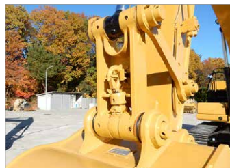
全格納式フックタイプ吊具
