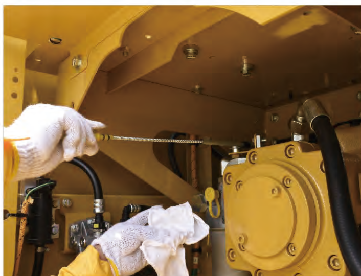
エンジンオイルもグラウンドレベルからチェック可能
