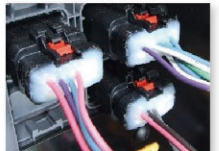
シリコンシーリング （露出電子端子部） トンネル現場内の粉塵・ 水滴等による接触不良 トラブル低減
