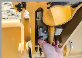
ショベルクレーン ワンタッチで簡単にフックを 取り出し・格納できます
