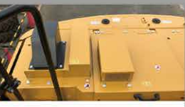
林業仕様エンジンフード 上からの木屑等の侵入を防止
