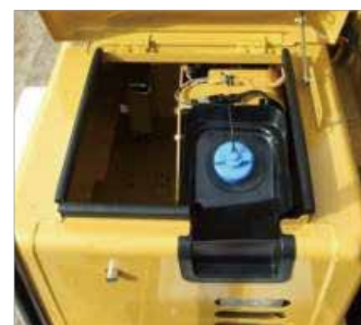
尿素水タンク (車体右前)
