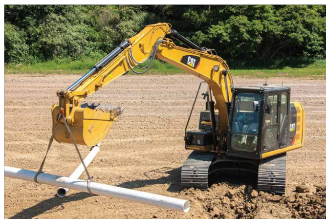
クレーン仕様機 (海外仕様のため一部国内仕様とは異なります)
