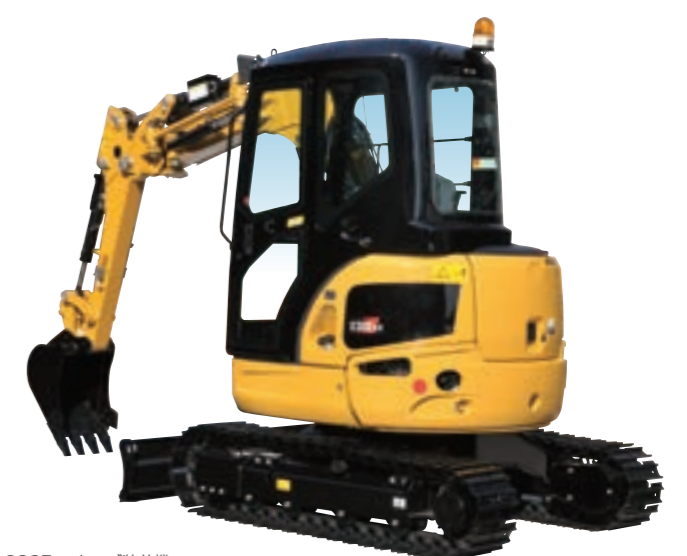
030ESR キャブ装着機 (キャブ/ショベルクレーン/アタッチメント用油圧配管/ダブルグロースチャーはオプションです。)
