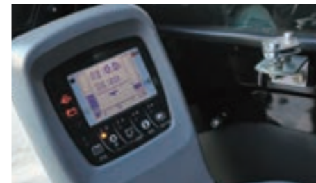
クレーンモード時のグラフィックモニタと水準器
